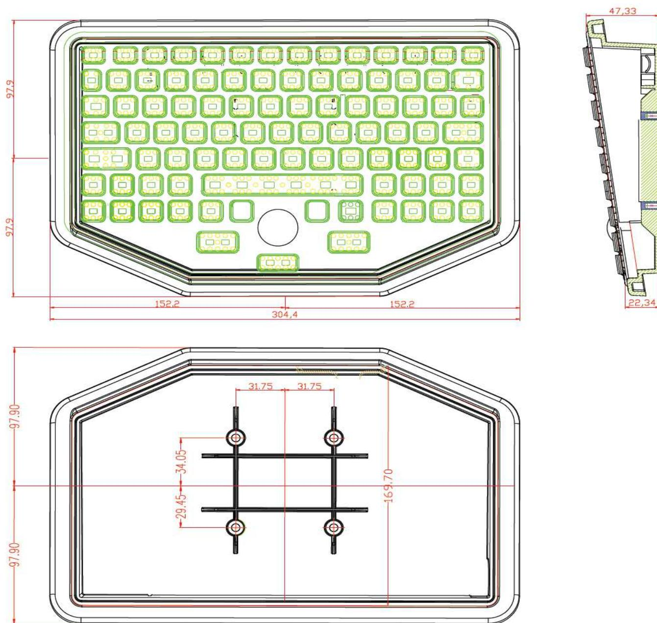
**Possibilité de fixation sur support au moyen de 4 vis sur les 4 inserts présents sur le fond du boîtier**
